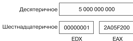
Рис. 4.6. Результат умножения сохраняется в регистрах EDX и EAX
