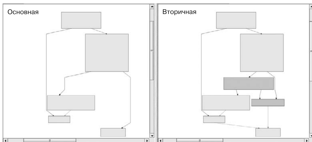
Рис. Б.1. Отсутствие фрагмента кода в одном из вариантов при сравнении двух функций с помощью BinDiff
