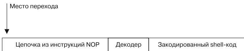
Рис. 19.3. Размещение цепочки из инструкций NOP и кода командной оболочки
